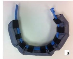
איור 1: קולר ה-GPS וחלקיו: (א) מכשיר ה-GPS (ב) סוללה חיונית (ג) הקולר המורכב (ד) הרכבת הקולר סביב צוואר העז
